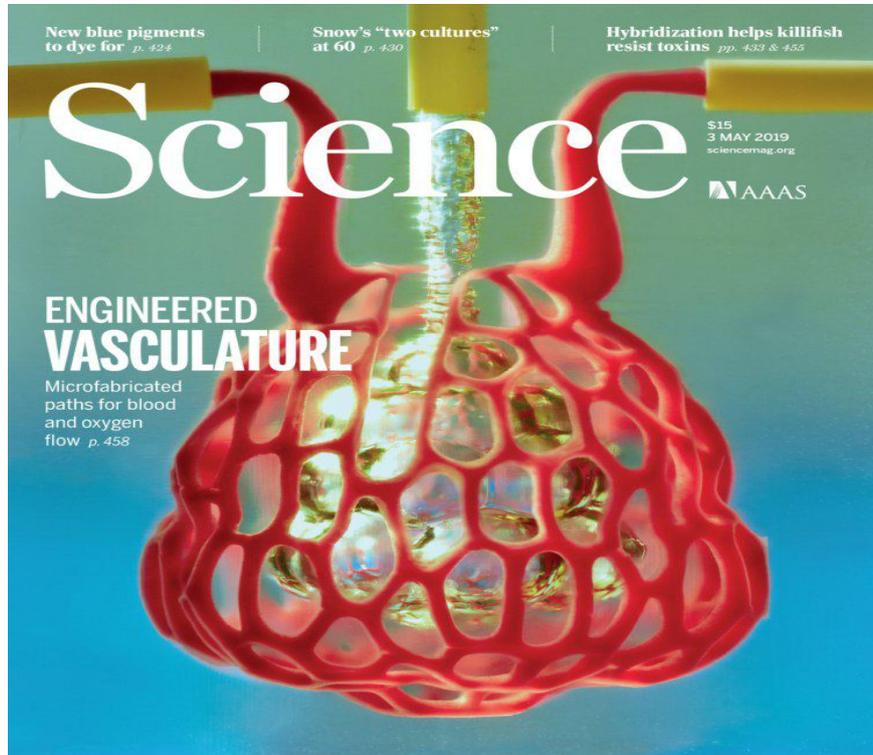
“空气被泵入网络，它汇集在球状气囊上，这些球囊为网络的每个尖端加固。” Nervous System 在他们的案例研究中表示， “这些囊袋通过呼吸动作有节奏地膨胀和收缩，所谓的潮汐通气，因为人体肺部的气流让人联想到海洋潮汐的流动。“接下来，我们会在呼吸道周围形成双重血管网络。一个带来脱氧血液，另一个带载氧气的血液。这两个网络在气道的尖端处连接在一个细小的血管网中，这使得球根状气囊成为可能。这些容器只有 300 微米宽”！
